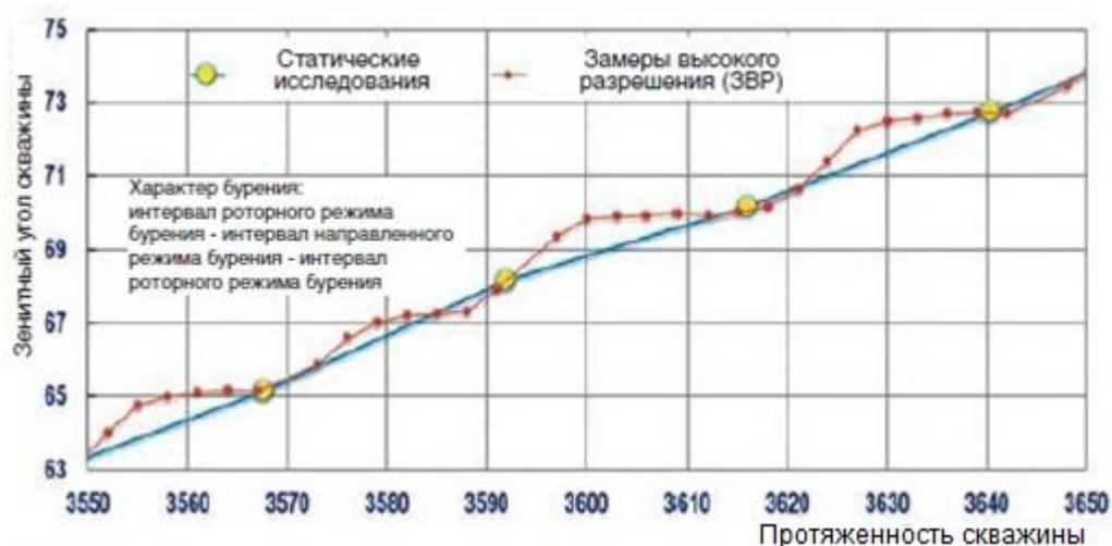
Рисунок 2 – График плотности замеров зенитного угла с помощью ТС Sperry San по сравнению со статическими исследованиями
