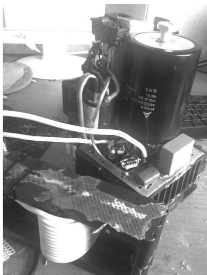
***Рис.2. Исследовательский макет полумостовой установки***
