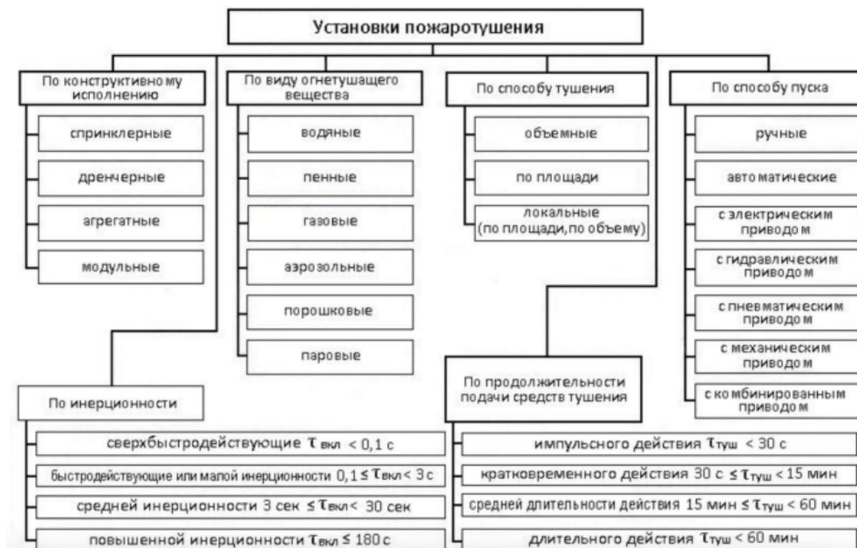
Рис. Классификация установок пожаротушения
