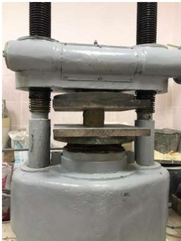
*Рисунок 5. Гидравлический пресс ПСУ-10*
