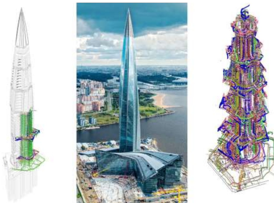
Рис. 1 Внутреннее сооружение Лакта Центра в BIM-модели Autodesk Revit — программа для BIM №1
