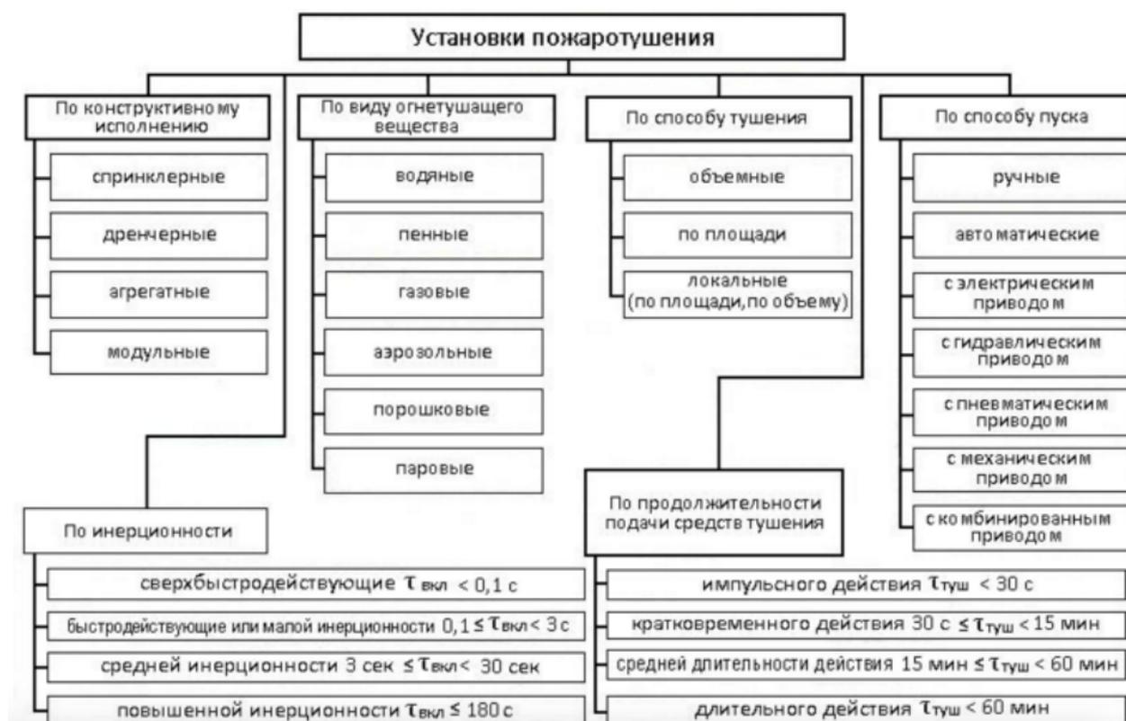
Рис. Классификация установок пожаротушения
