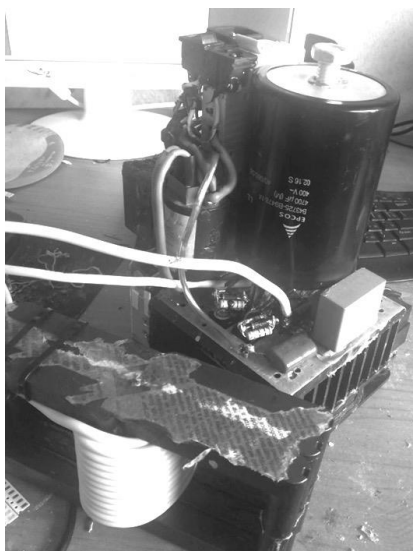
Рис.2. Исследовательский макет полумостовой установки
