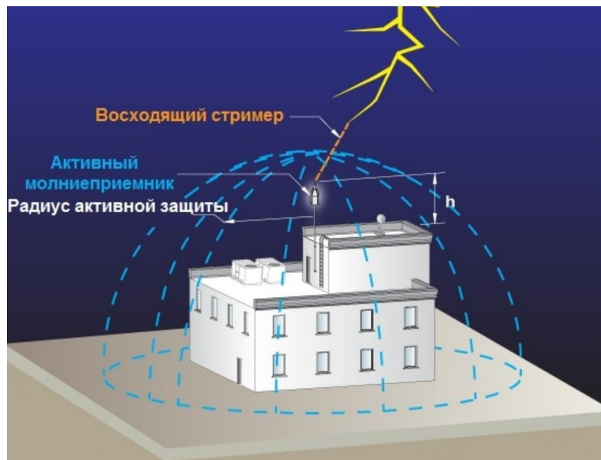
Рисунок 2. Площадь, защищаемая активным молниеприемником
